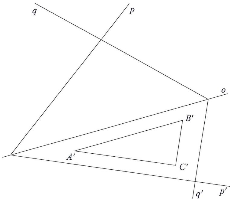
**Příklad 90:** Osová afinita je dána osou  $o$  a dvojicí odpovídajících si bodů  $A, A'$ . Sestrojte obrazy  $p', q', r'$  rovnoběžek  $p, q, r$ .
